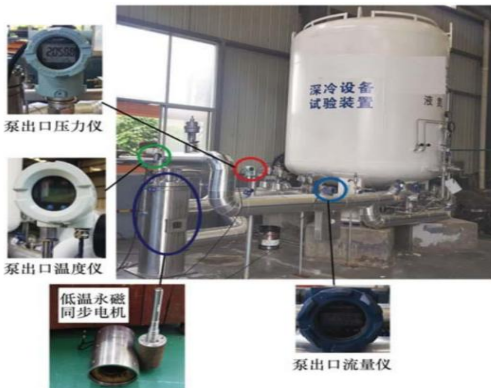
图 2-3 潜液（LNG）深冷高效永磁同步电机实验设备
