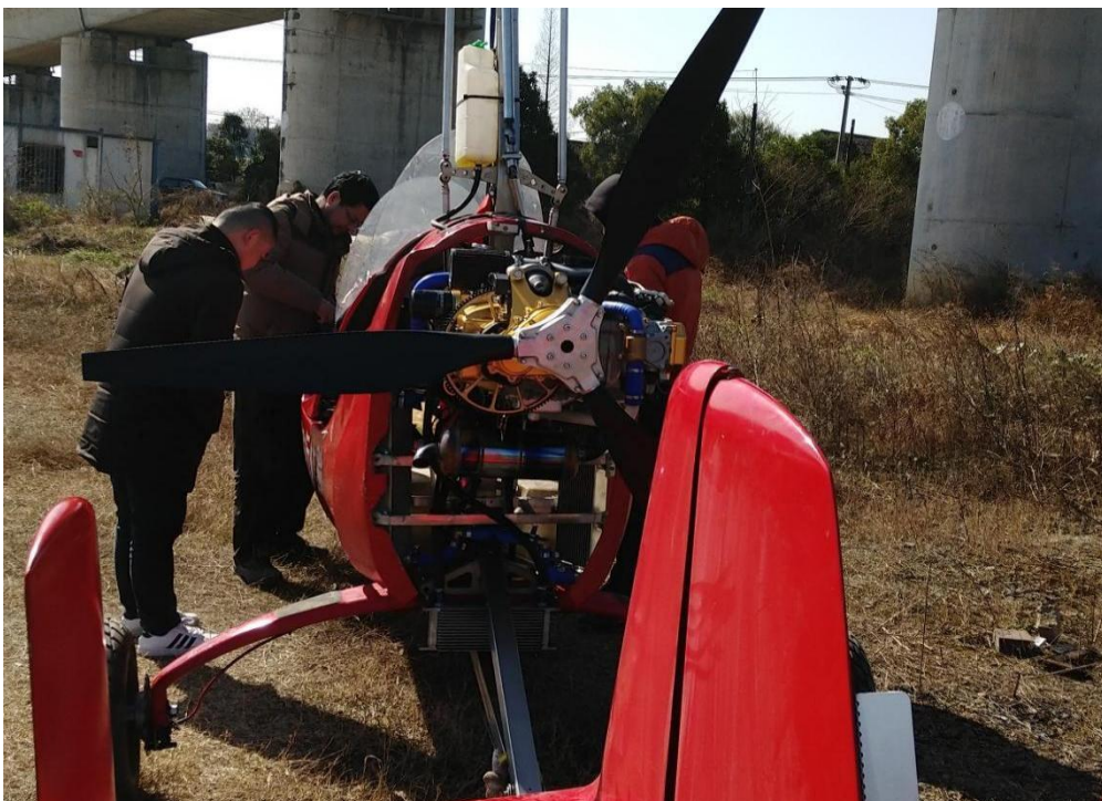
图 2-2 对 1500 系列发动机进行现场测试
